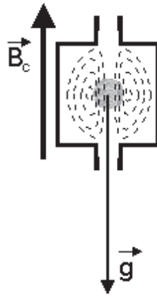
FIG. 3.21 – Effet(s) Doppler avec Horace. Les atomes chutent dans l’axe défini par \vec{g} . La vitesse des atomes selon l’axe de chute disymétrise la distribution de vitesse. Le produit de la vitesse des atomes selon l’axe de chute par le gradient de phase du champ micro-onde contribue à un déplacement de fréquence par effet Doppler résiduel du premier ordre.
