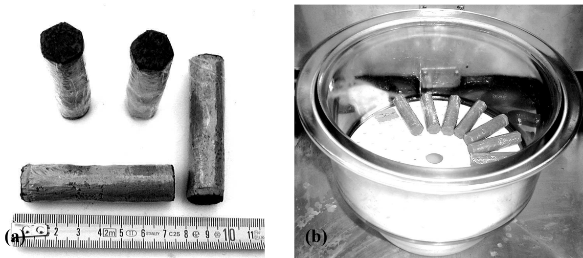
Photographie III.2. Échantillons cylindriques de sable limoneux argileux.
