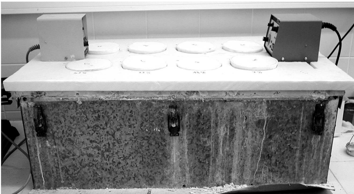
Photographie II.5. Vue d'ensemble du dispositif « banc de sorption en température ».
