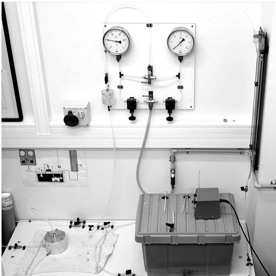
Photographie II.4. Vue d'ensemble du dispositif « plaque de pression en température ».
