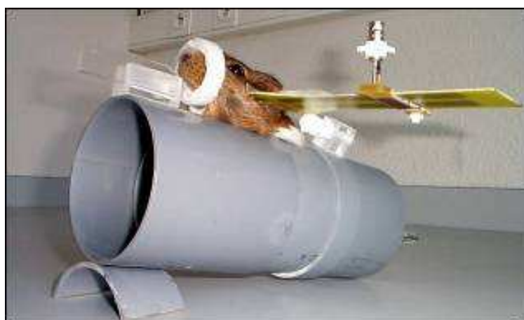
FIG. 1.10 – Système d'exposition "tête-seule" utilisé sur un cobaye
