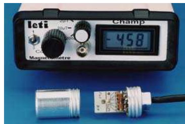
Figure 46 : Capteur magnétique utilisé et son électronique associée
