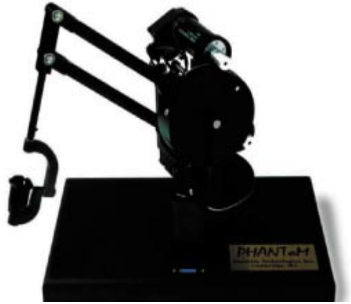
figure 2.1 : Le système à retour d'effort Phantom de chez Sensable.
