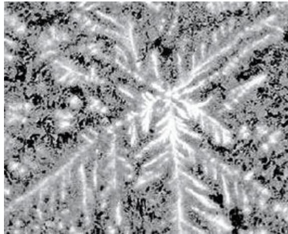
Figure 6 : Observation par MEB d'une zirconolite contenant des ions lanthanide, obtenue par un procédé de fusion [FIL02]. Echelle : 1cm équivaut à 10 \mu m
