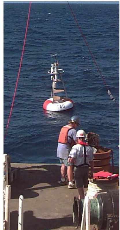
Figure 1.3: En haut à gauche, schéma de principe d'un mouillage ATLAS (Autonomous Temperature Line Acquisition System) de nouvelle génération équipé à la fois de courantomètres sur le câble de la bouée entre 0 et 300 m et d'un mouillage en sub-surface vers 300 m équipé d'un profileur ADCP orienté vers la surface. En haut à droite, récupération délicate du mouillage de sub-surface, de son profileur ADCP, et de ses précieuses informations à 0°,170°W, après 6 mois de bons et loyaux services. En bas, la dernière bouée ATLAS mise à l'eau avant que l'un des moteurs du Ka'imimoana ne lâche.
