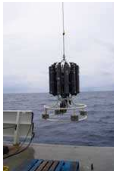
Figure 1.4 : Jason s'acharnant sur la CTD mystérieusement défectueuse (à gauche). A droite, la CTD entièrement montée et prête à être mise à l'eau.
