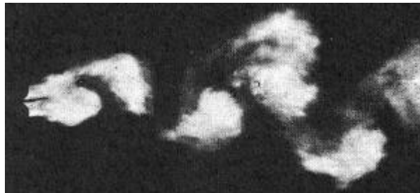
Figure III-1.11 : Visualisation de l'écoulement pour d = 1.05D (QUADFLIEG, 1977).
