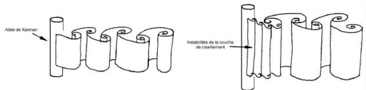
Figure III-1.2 : Développement des instabilités dans le proche sillage (d'après WILLIAMSON, 1996).
