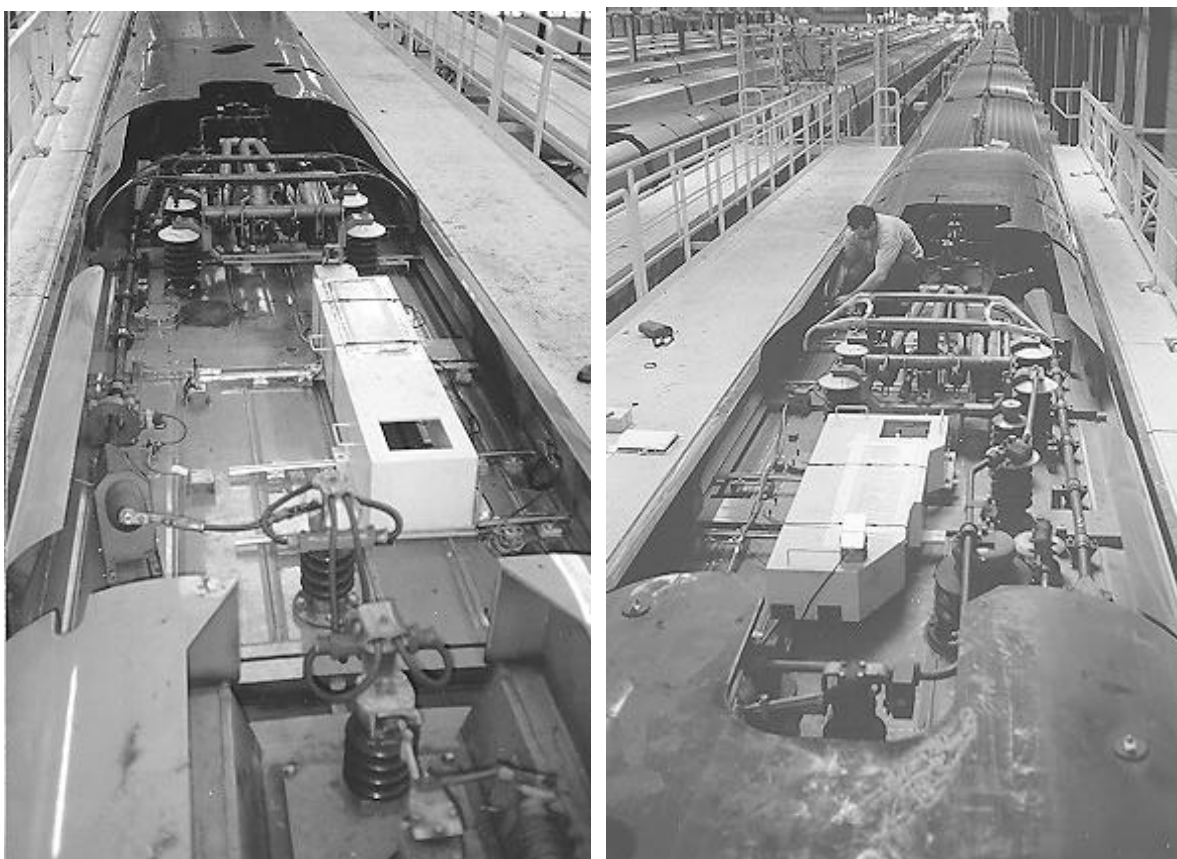
Figure II-1 : Géométrie réelle de la baignoire du pantographe a) vue vers l'avant de la motrice et b) vue vers l'aval du train.
