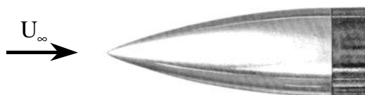
Figure II-4.1 : Ogive aérodynamique du microphone 1/2 pouce (type UA 0386).
