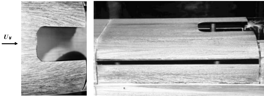
Figure II-3.2 : Visualisations au-dessus et sur l'un des côtés du capot.
