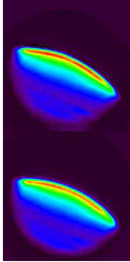
FIG. 8.2 : Image des 2 sorties de BEAR, obtenue en sommant un cube d'interférogramme sur la dimension spectrale. Cette image a pour dimensions 72 \times 144 pixels.
