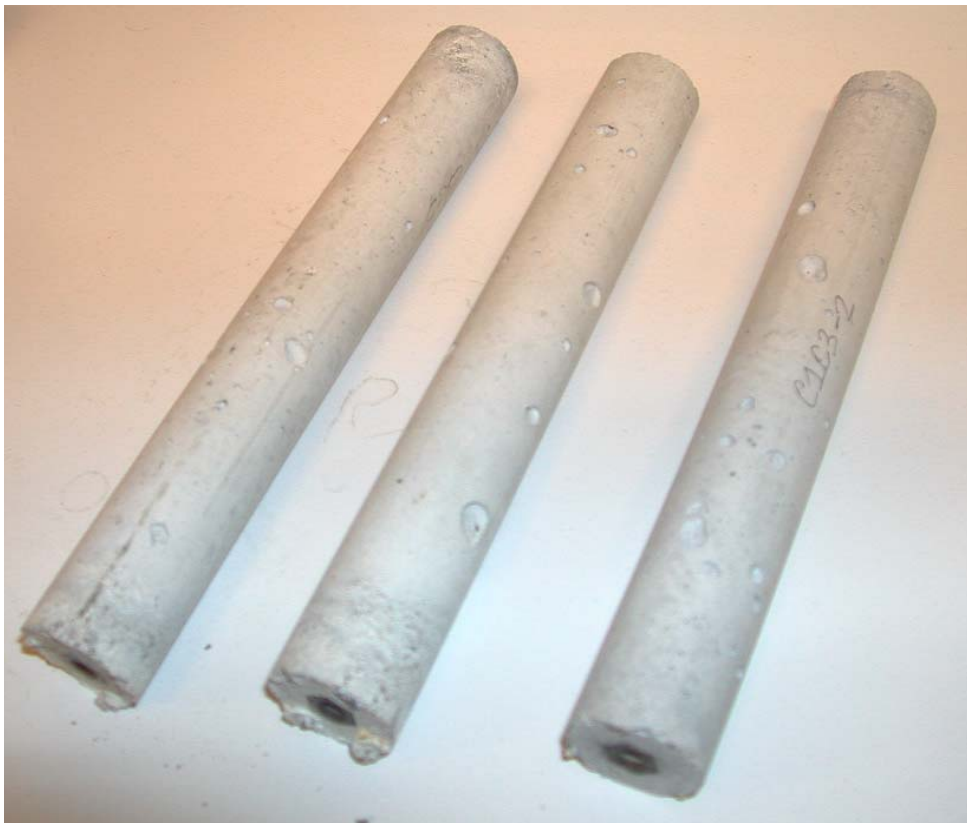
Figure 186 : exemples d'éprouvettes cylindriques après démoulage. Nous pouvons remarquer l'état de surface correct ainsi que la qualité de finition des éprouvettes.
