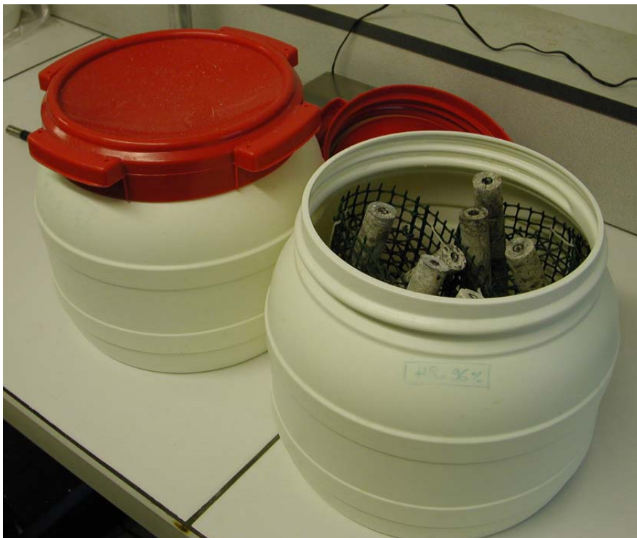
Figure 188 : conservation des éprouvettes des séries HR-constante et HR-variable. Les éprouvettes sont maintenues verticales dans des containers étanches au-dessus de la solution saline au moyen de paniers.
