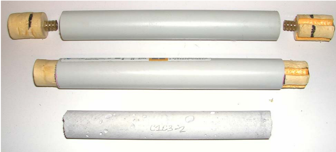
Figure 185 : fabrication des éprouvettes cylindriques. Nous pouvons voir les moules utilisés pour le coulage ainsi que les bouchons munis de leur plot de retrait.
