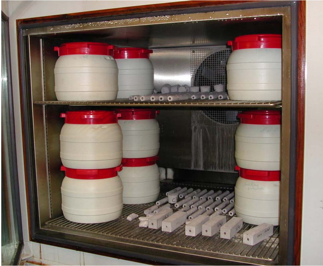
Figure 189 : conservation des éprouvettes. Les éprouvettes de toutes les séries sont maintenues à la température de 60°C. Les éprouvettes des séries Granulo1 et Granulo2 sont conservées directement dans l'enceinte climatique. Les containers contiennent les éprouvettes des séries HR-constante et HR-variable.
