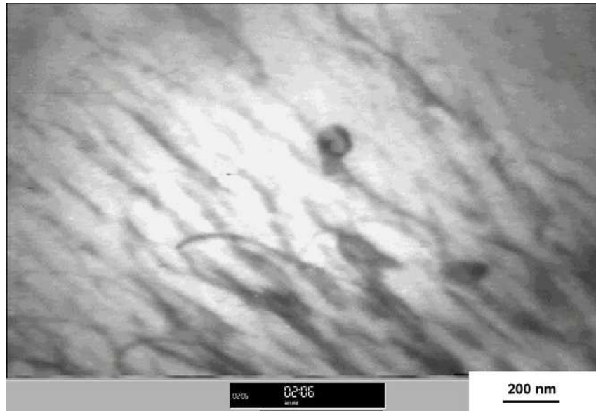
FIG. 2.84 – Dislocations courbées glissant dans le matériau non irradié.
