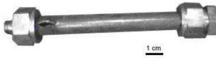
FIG. 2.8 – Eprouvette C après éclatement.
