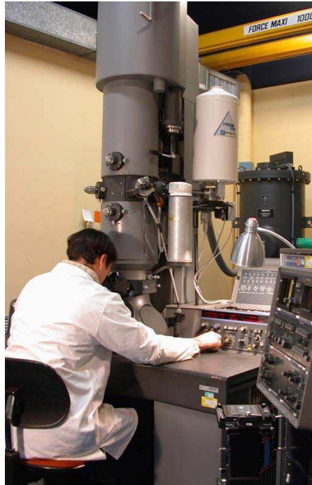
FIG. A.4 – Microscope électronique en transmission 300 kV Phillips EM430.
