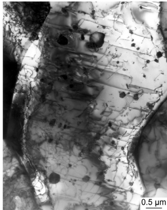
FIG. 2.3 – Vue générale d'un grain après une déformation de 1% ( M_4 ).
