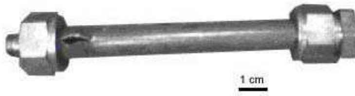
FIG. 2.8 – Eprouvette C après éclatement.
