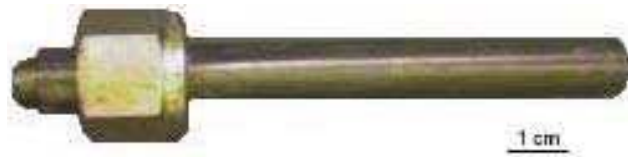
FIG. 2.9 – Eprouvette D après essai mécanique.
