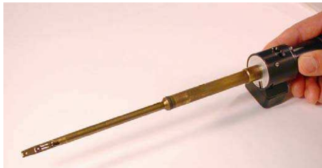
FIG. A.2 – Porte-objet double tilts ( \pm 45^\circ, \pm 30^\circ ) du microscope Phillips EM430.
