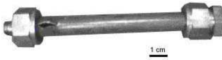
FIG. 2.8 – Eprouvette C après éclatement.
