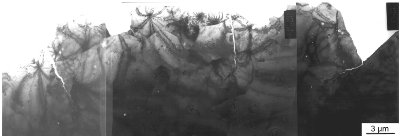
FIG. 2.28 – (a) Cliché MET d'un grain de l'éprouvette A contenant des canaux basaux, (b) projection stéréographique du grain à tilts nuls, (c) projection stéréographique du grain correspondant à l'orientation du cliché.
