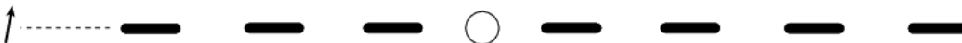
FIG. III.15 – Représentation schématique du déconfinement du spin \frac{1}{2} ( \uparrow ) libéré par l'impureté non magnétique ( \circ ) dans la chaîne MG. Les dimères, symbolisés en noir, représentent les états |\Phi_1\rangle et |\Phi_2\rangle , de part et d'autre de l'impureté.
