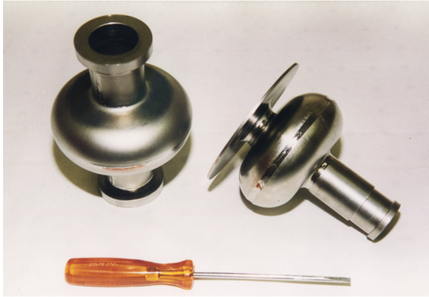
Figure 5.6: Forme des cavités ayant servi à la mesure de la profondeur de pénétration (cavité de gauche) et au champ magnétique maximum (cavité de droite)
