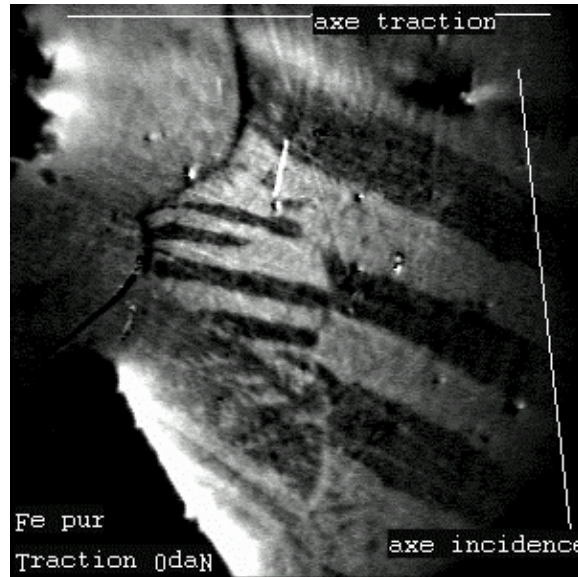
Photo II-3 : Exemple d'observation au microscope à effet kerr d'une surface couverte de diélectrique d'après TAPULEASA [55]
