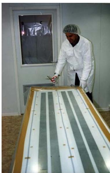
Figure 3.6: Préparation, dans la salle propre de NEMO au LSM, des feuilles sources métalliques de  $^{116}\text{Cd}$  qui sont installées dans le secteur 18.
