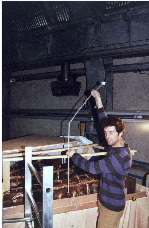
Figure 8.7: La tige support de source est insérée dans le tube d'étalonnage.
