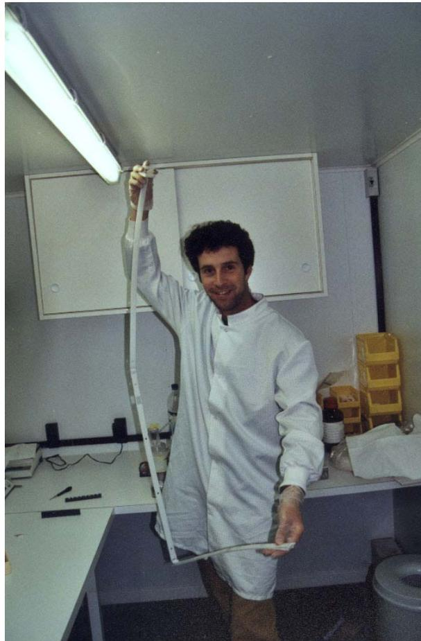
Figure 8.2: Tige plastique pliable en 4 morceaux de 3 m de longueur pouvant accueillir 3 sources  $^{207}\text{Bi}$ .
