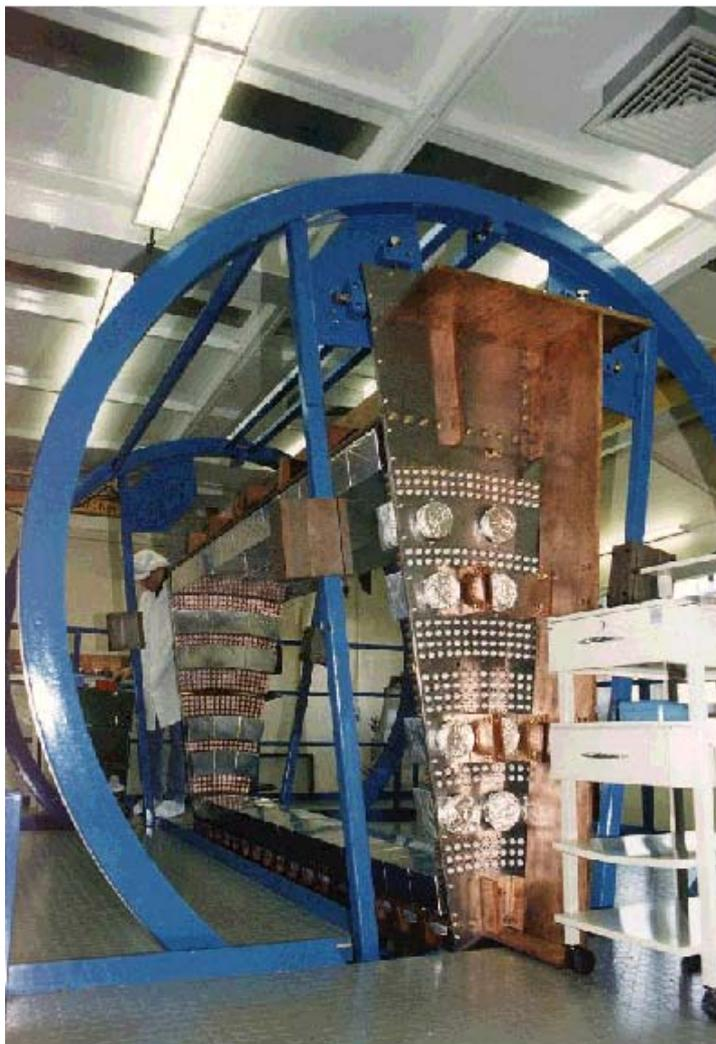
Figure 3.18: Photo du vireur ayant servi au tissage de la chambre à fils de NEMO3.
