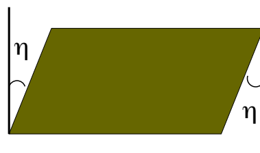
Forme parallélogramme d'une section de barre de quartz
