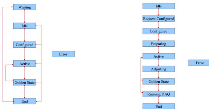
Figure 3.15: Détails des différents états Fsm accessibles pour un serveur donné (schéma de gauche) et pour une partition complète (schéma de droite) ; figures extraites de [59].
