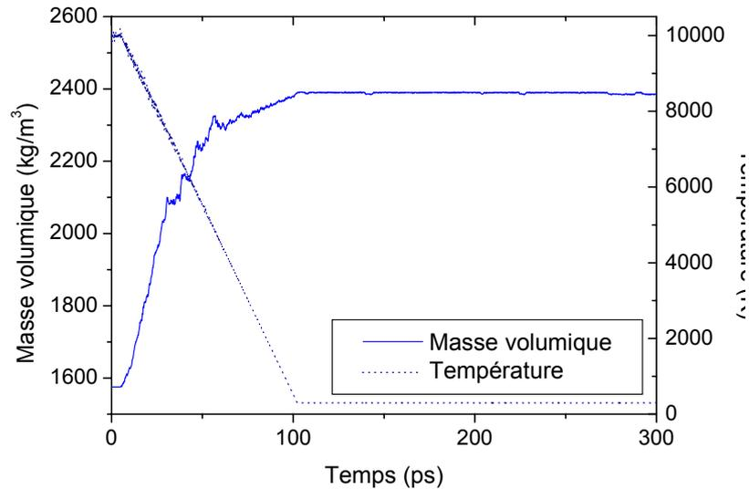
Figure IV-13. Evolution de la masse volumique de la silice lors de la trempe de 10000 à 300 K
