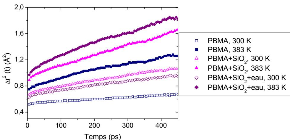
Figure IV-27. Carré des déplacements moyens des atomes de type "CH<sub>3</sub>" du PBMA à 1 bar
