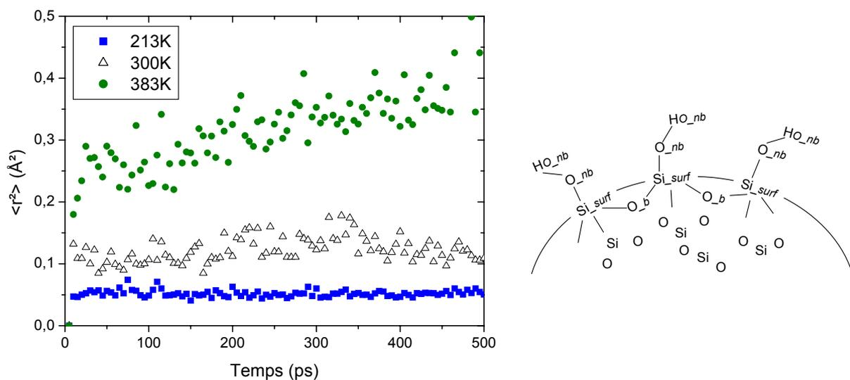
**Figure IV-25.** Carré du déplacement moyen de la nanoparticule de silice pour le système PBMA-SiO<sub>2</sub>-eau à 1 bar
