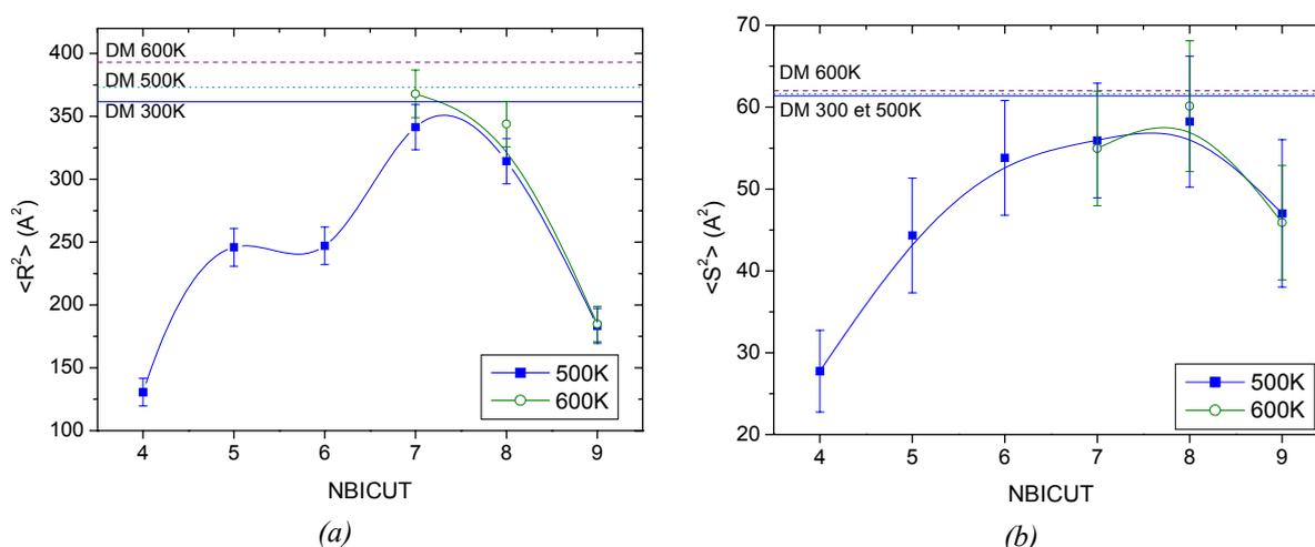
**Figure IV-10.** Moyennes (a) des carrés des distances entre bouts de chaînes et (b) des rayons de giration pour le décamère atactique
