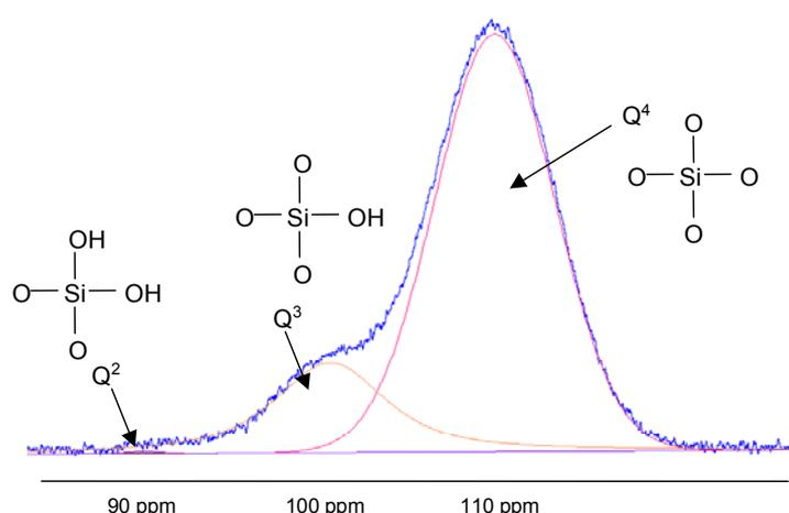
Figure II-11. Spectre RMN du <sup>29</sup>Si de la silice pure
