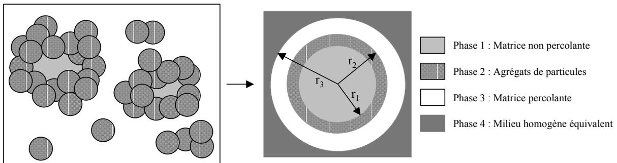
**Figure IV-1.** Représentation schématique des nanocomposites renforcés par  $V_F < V_C$  et motif morphologique associé
