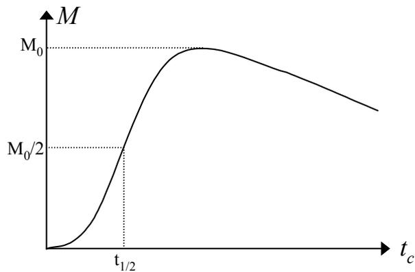
**Figure III-50.** Définition du temps  $t_{1/2}$
