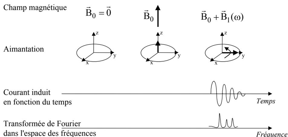
**Figure II-17.** Principe d'une expérience de RMN
