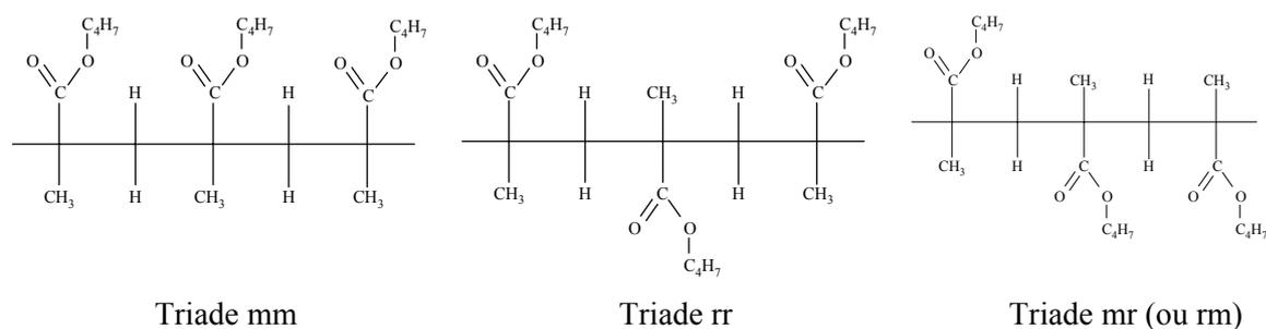
Figure II-4. Les différentes triades du PBMA
