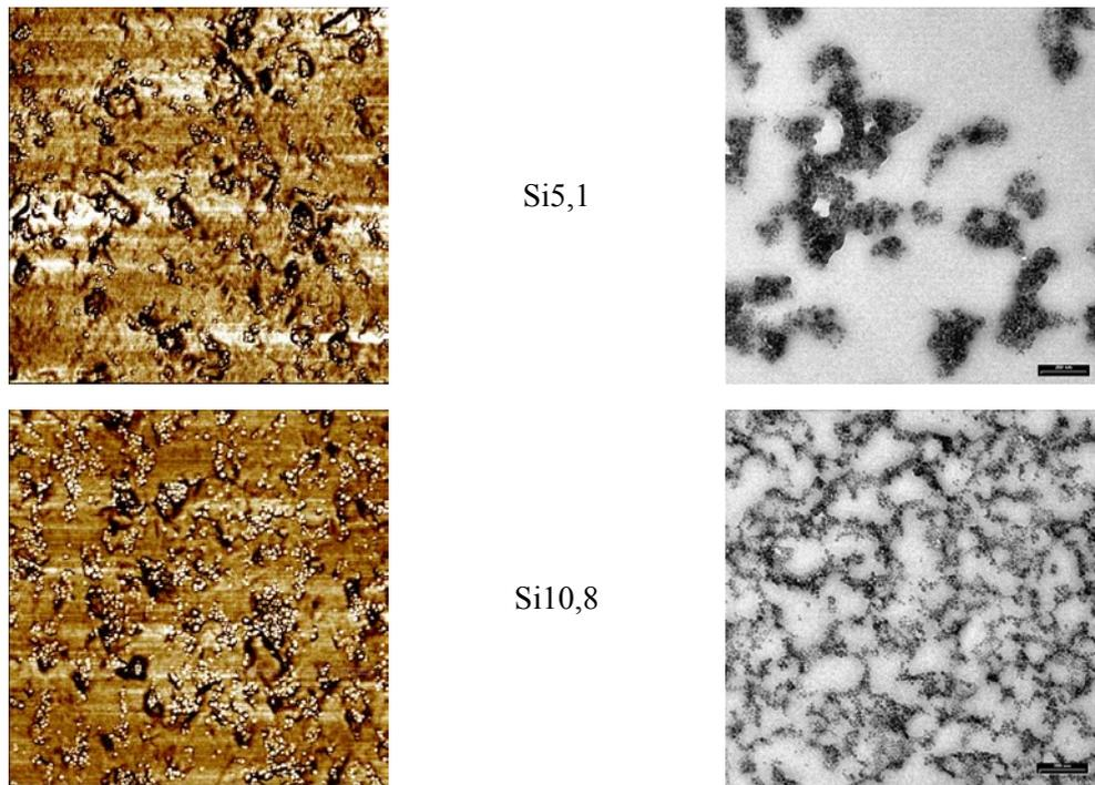
**Figure III-21.** Comparaison des images obtenues par AFM (à gauche, 2 x 2  $\mu\text{m}$ ) et par MET (à droite, 1,7 x 1,7  $\mu\text{m}$ )
