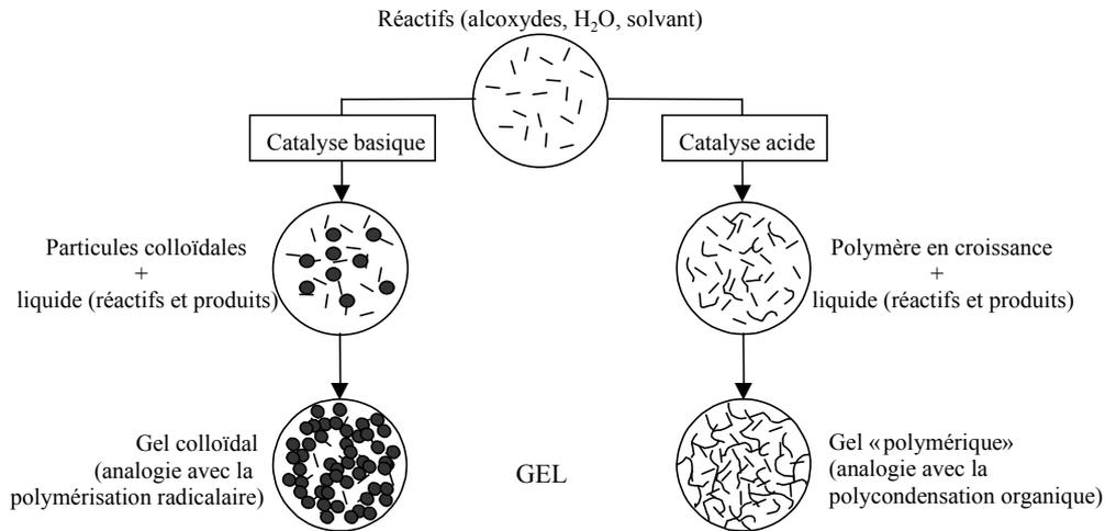
Figure I-1. Influence du type de catalyse sur la formation du gel inorganique
