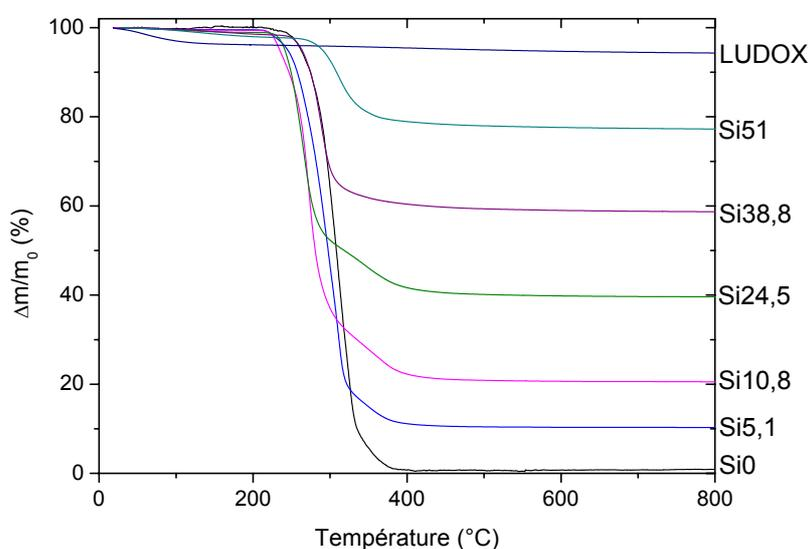
**Figure III-1.** Thermogrammes ATG des différents nanocomposites étudiés
