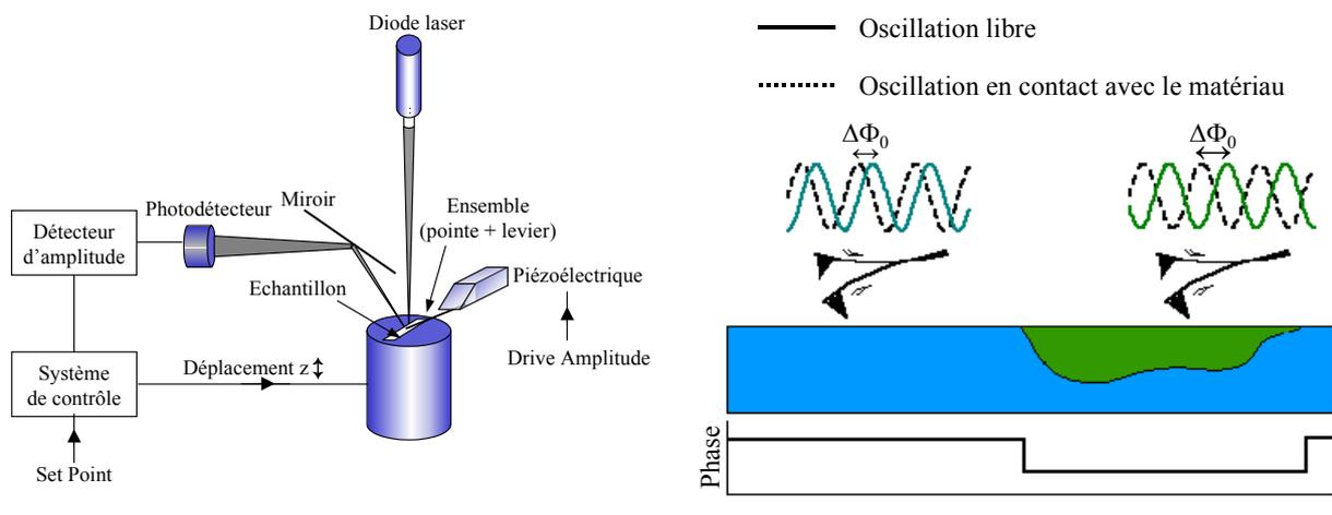
Figure II-13. Principe du mode contraste de phase
