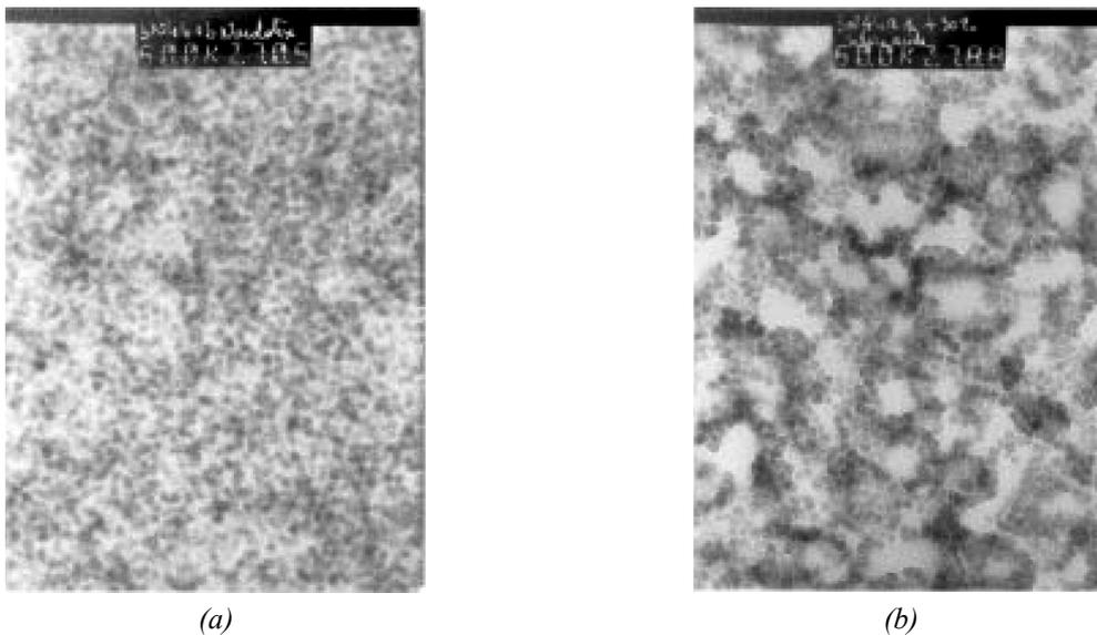
**Figure I-18.** Observations par MET. de films de P(BA-co-MMA)+13,6% SiO<sub>2</sub> élaborés en solution (a) basique ou (b) acide [64]
