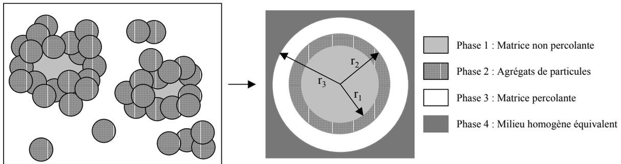
**Figure I-30.** Illustration du modèle à  $(n+1)$  phases utilisé par Albérola et Mélé [109, 121]
