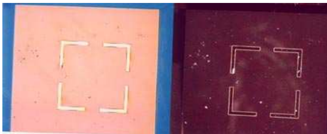
Figure II-26. Membranes 2 \times 2 \text{ mm}^2 réalisées par gravure KOH sur wafers de silicium pur. L'épaisseur des membranes est d'environ 1 \mu m , pour une épaisseur de wafer de 300 \mu m au départ. Des cadres en or servant à homogénéiser la température apparaissent au centre des membranes.
