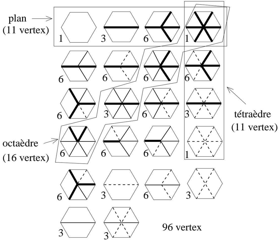
**Fig. 11:** Les 96 configurations de pliage d'un hexagone élémentaire. Les plis complets sont indiqués par un trait gras, les plis obtus par un trait fin et les plis aigus par un trait pointillé. Sous chaque environnement, on a indiqué sa multiplicité correspondant aux rotations de l'hexagone. On a indiqué également les vertex à retenir pour les trois sous-modèles correspondant aux pliages plan (11 vertex), sur un seul tétraèdre (11 vertex) et sur un seul octaèdre (16 vertex).
