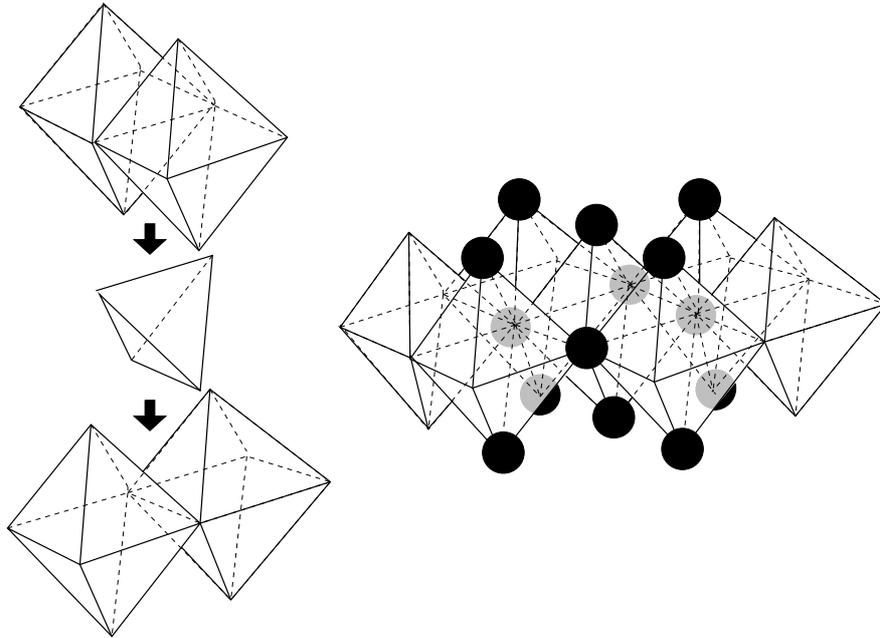
**Fig. 7:** Le réseau CFC vu comme un empilement d’octaèdres et de tétraèdres. Les sommets (sphères noires) des octaèdres se placent aux sommets de cellules cubiques ainsi qu’au centre des faces de ces cellules.
