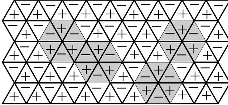
**Fig. 4:** En partant de la configuration complètement repliée, on peut retourner les 6 spins d'un hexagone élémentaire (ici en grisé) et conserver une configuration admise. Ce retournement est possible simultanément pour plusieurs hexagones tant qu'ils ne se chevauchent pas (hexagones durs).
