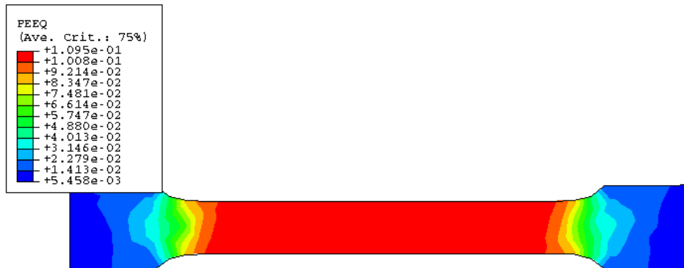
FIG. 2.1: Simulation numérique de l'essai de la traction simple (essai homogène).
