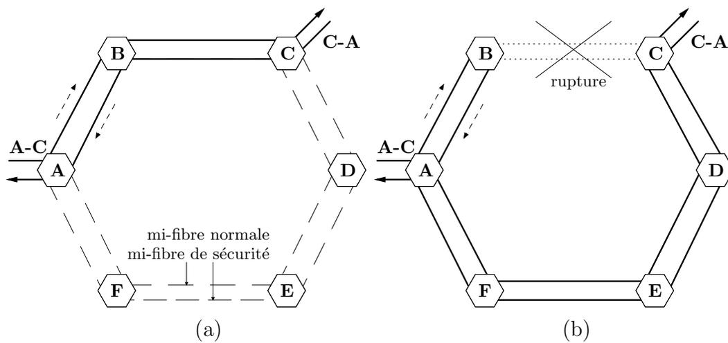
Figure 1.4 – Un anneau bidirectionnel (réseau SONET).
