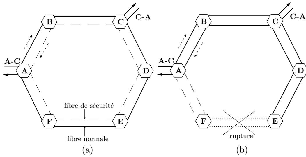
Figure 1.3 – Un anneau unidirectionnel (réseau SDH).
