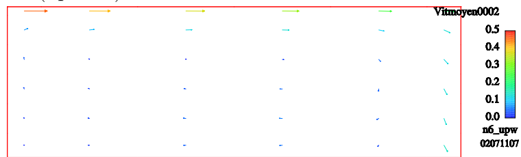
FIG. A.21 – Comparaison des profils de vitesse pour différentes valeurs de \mu pour le maillage nielsen6 (upwind)
