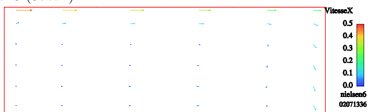
FIG. A.49 – Comparaison des profils de vitesse pour différentes valeurs de \mu pour le maillage nielsen6 (Jasak)
