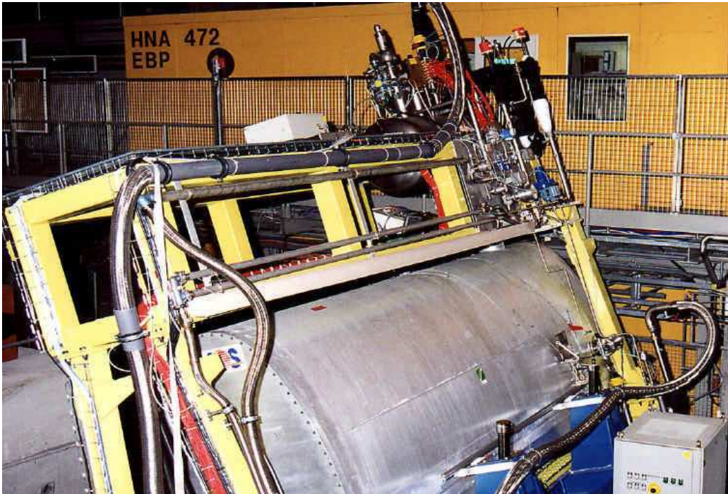
FIG. 4.1: Cryostat utilisé pour les tests sous faisceau
