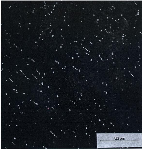
Figure I. 15 : Précipités coalescés alignés sur des dislocations après 331h à 640°C [Bošanski et al., 1977].
