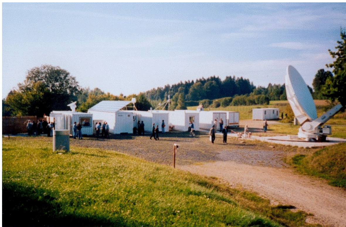
Figure B.1 : TIGO durant les tests à Wettzell (Allemagne) en 1998. Le container de gauche correspond au module de télémétrie laser et à son télescope. Les deux autres contiennent l'alimentation électrique produite à partir d'énergie solaire en tant que source ininterrompue, les capteurs météorologiques, les horloges atomiques et les étalons de fréquence, l'ordinateur et les équipements de transmission des données. Le module VLBI et son antenne radio pliable sont situés sur le côté droit.
