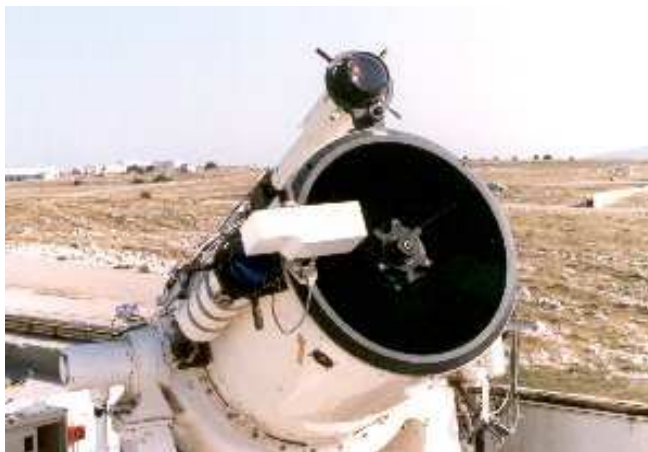
Figure 2.2 : Télescope de la station laser satellites fixe du plateau de Calern. Sur la gauche de celui-ci, on distingue l'optique d'émission du laser et l'équerre optique (boîte blanche) servant pour les mesures d'étalonnage. Sur le haut se trouve la lunette de visée.
