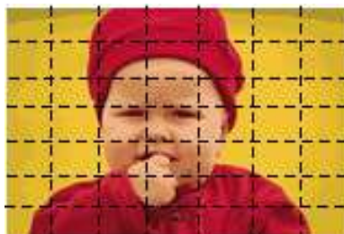
FIG. 3.2 – Lieux des pixels définissant les prototypes couleur initiaux. Ces prototypes sont les pixels situés aux intersections intérieures d'une grille 7 \times 7 afin de couvrir les différents lieux de l'image (à l'exception des bords de la grille). Nous définissons ici 36 prototypes initiaux.
