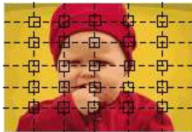
FIG. 3.5 – Lieux des LDQC définissant les prototypes initiaux. Ces LDQC-prototypes sont choisies comme celles centrées aux intersections intérieures d'une grille 6 \times 6 afin de couvrir les différents lieux de l'image (à l'exception des bords de la grille). Nous avons donc ici 25 prototypes initiaux.
