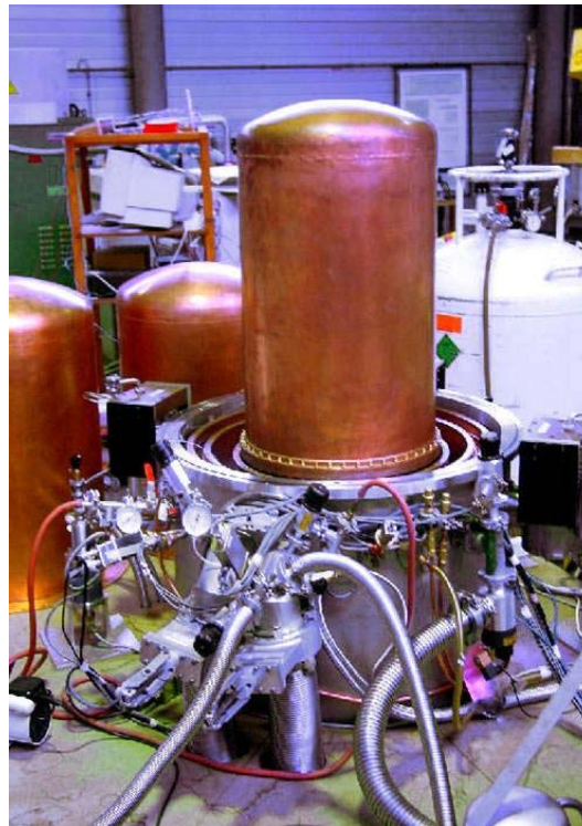
FIG. 4.1 – Disposition hexagonale des détecteurs dans l'expérience EDELWEISS-II. Ce dispositif peut accueillir jusqu'à 120 détecteurs germanium de 320g. Ces détecteurs reposent sur des plaques de plomb archéologique pour les protéger du bruit de fond gamma.
