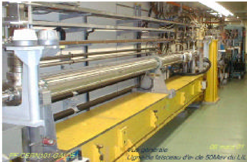
Figure III-8 : La section accélératrice
