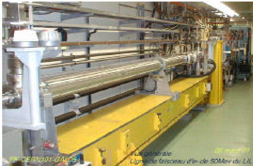
Figure III-8 : La section accélératrice
