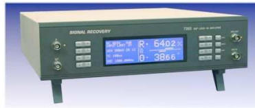
FIG. 3.14 – Détecteur Synchrone (LIA) utilisé en mode alternatif
