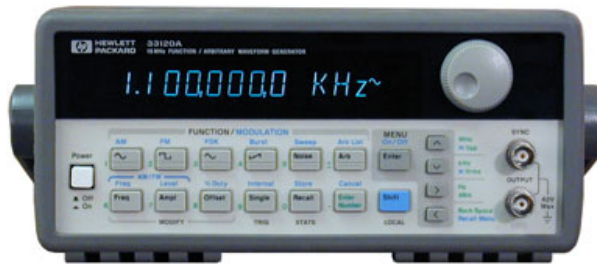
FIG. 3.11 – Générateur de signal utilisé en mode AC.
