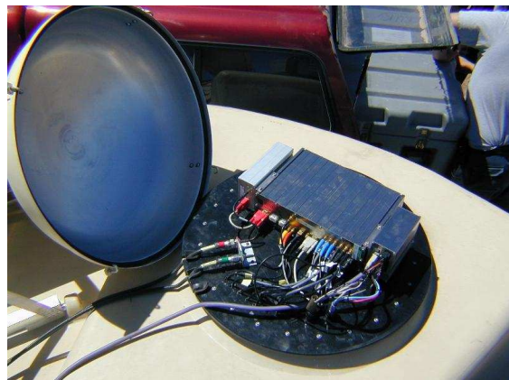
Figure 19 : Intégration de l'électronique sur un détecteur de surface
