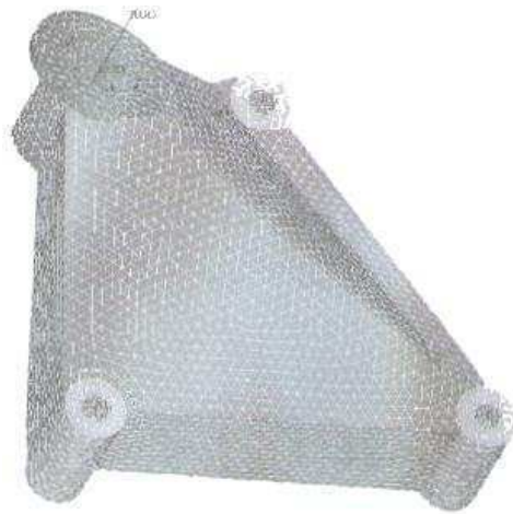
FIG. 1.10 – Encombrement maximal d'un support de boîte de vitesse.
