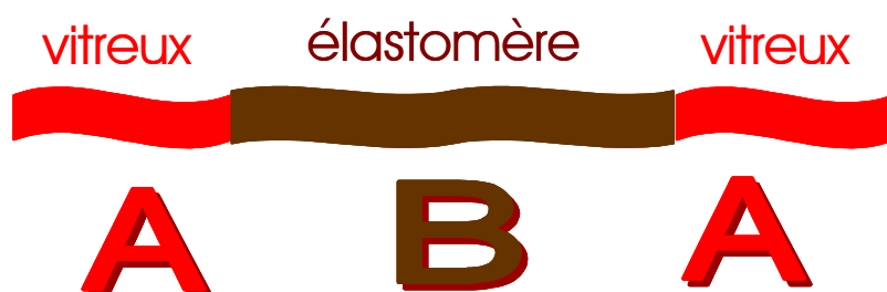
Figure 2.6: Macromolécule linéaire de copolymère triséquencé. Un segment central élastomère est lié de manière covalente à deux segment vitreux. Chaque segment contient un seul type de monomère.
