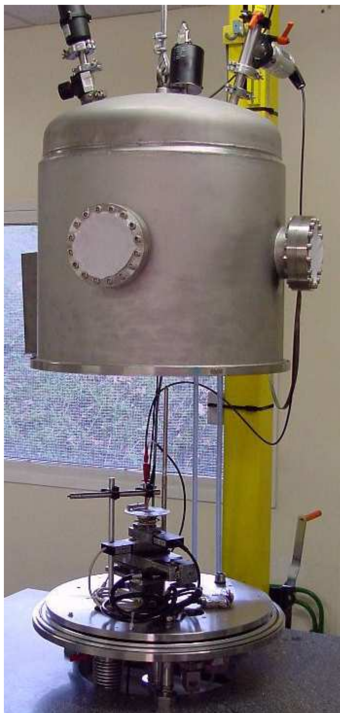
FIG. 4.1 – Enceinte utilisée pour les mesures de conductivité ionique en fonction de la température.
