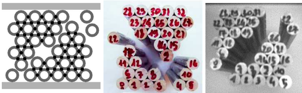
FIG. 3.44 – Echantillon après rupture pour un défaut en position 13
