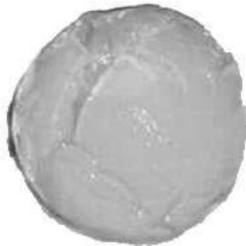
FIG. 4.28 – Fissuration à la surface d'une sphère de gel d'agar soumise à une déshydratation osmotique [Richefeu et al., 2002]
