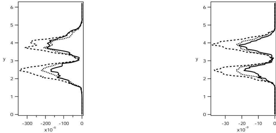
**FIG. 6.34:** Modélisation des termes de pression-viscosité et de croisement de trajectoire de l'équation de vitesse de dérive  $U_d$  au temps  $t/t_{tr} \approx 0.8$ . A gauche : cas n°1 ( $St = 0.11$ ,  $\phi = 1.$ ), à droite : cas n°2 ( $St = 0.26$ ,  $\phi = 1.$ ); — : terme extrait de la "DNS", ..... : modèle "simplifié" (éq. 2.93), --- : modèle "intermédiaire" (éq. 2.96,  $\beta_2 = 0.6$ ).
