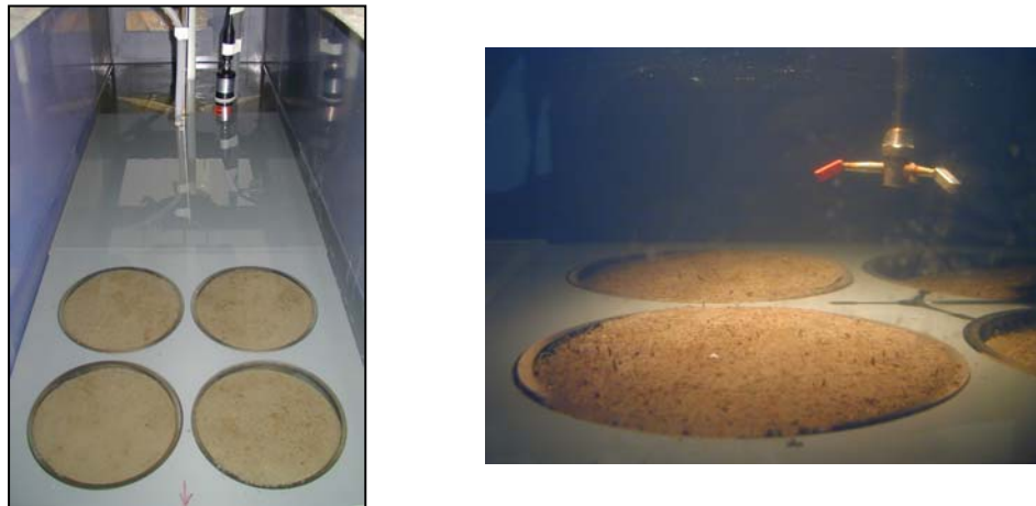
Figure 4-12 : Section test du canal à courant avant une expérience de remise en suspension.
