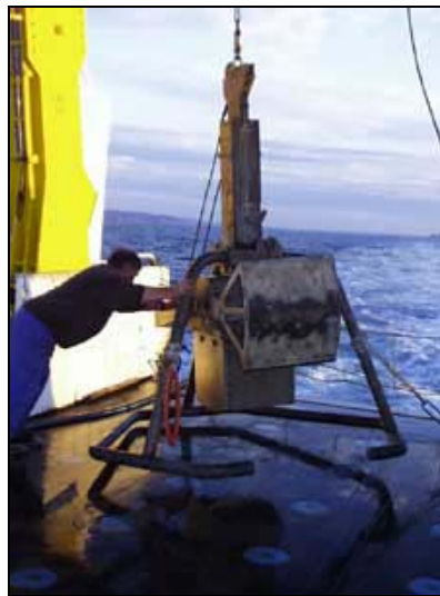
Figure 4-6 : Carottier boîte de type USNEL .
