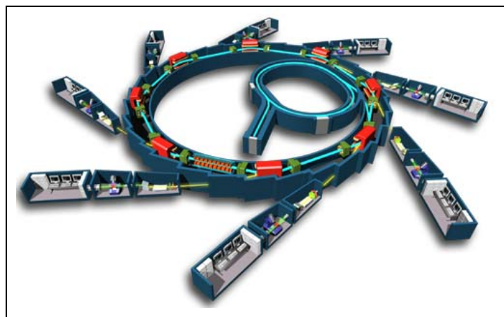
Figure 5 : Schéma d'un anneau de stockage. En bleu est représenté le faisceau d'électrons et en jaune, le rayonnement produit par courbure de leurs trajectoires par des wigglers ou des onduleurs (en rouge). 33 Les lignes de lumière sont situées après un élément de courbure. Elles sont constituées d'une cabine d'optique, suivie par la cabine d'expérience.
