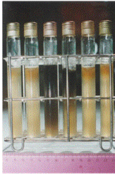
Photo 3 : Test qualitatif d'activité \beta -glucosidase de gauche à droite : Lactobacillus fermentum , Lactobacillus sake , Lactobacillus plantarum , Lactobacillus cellobiosus , Saccharomyces cerevisiae , Rhizopus oryzae (Photo Willie et Djoulde ENSAI 1999)
