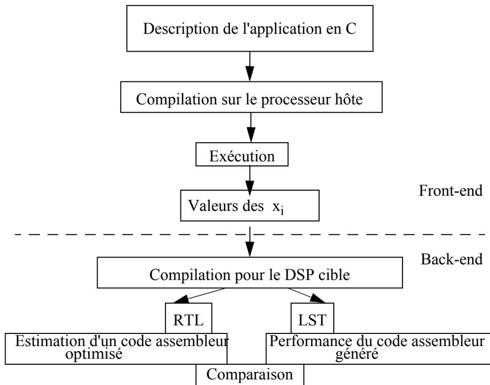
Le *front-end* décrit l'ensemble des phases dépendantes du langage source mais indépendantes du processeur DSP cible. Ici, on exécute le programme sur le processeur hôte avec une séquence de test afin d'obtenir une évaluation des valeurs des  $x_i$ . Le choix de la séquence de test est important pour obtenir une estimation réaliste.
