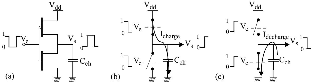
On représente le comportement de l'inverseur CMOS avec en entrée une transition descendante (figure 4(b)) ou une transition montante (figure 4(c)). On modélise les portes NMOS et PMOS comme étant idéales par des interrupteurs.
