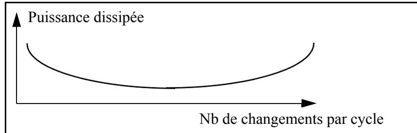
Le problème se pose de savoir comment déterminer le nombre optimal de points. Retenons seulement que les auteurs annoncent 90% de gain par rapport à un système sans gestion de puissance et 60% de gain pour un système qui modifie de manière dynamique les vitesses par rapport à un système à vitesse unique et mode veille.
