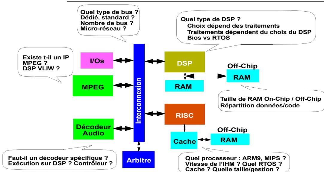
La détermination des composants présents dans ce système sur puce implique des techniques de conception conjointe logiciel/matériel. A partir d'un ensemble de modules disponibles (ASICs, FPGA, processeurs, mémoires, Network On Chip...), et à partir d'une description d'une application sous forme de tâches, la méthode de conception détermine les modules à affecter à l'exécution de chaque tâche de l'application.
