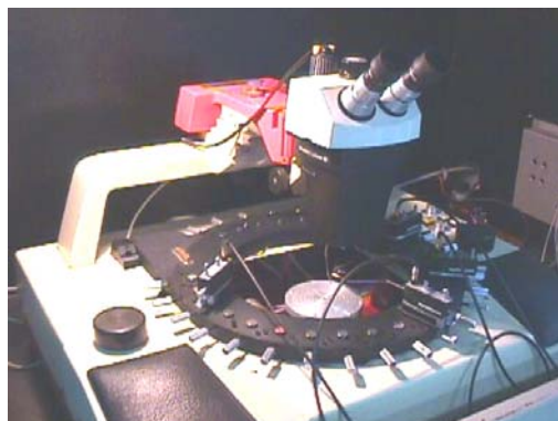
Figure 2.32. Montage de connexion les jonctions d'une diode à SPA
