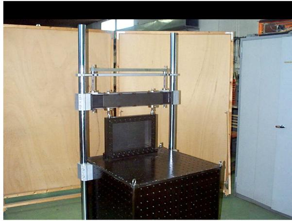
FIGURE VI.19 - Dispositif expérimental pour l'étude d'une plaque mince, éventuellement précontrainte
