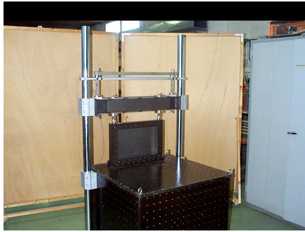
FIGURE VI.19 - Dispositif expérimental pour l'étude d'une plaque mince, éventuellement précontrainte
