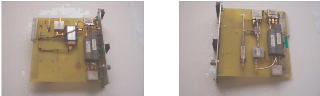
FIG. 3.12: Photo de la partie RF de l'émetteur
