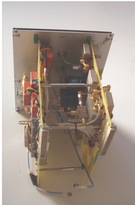
FIG. 3.14: Photo de la partie RF de l'émetteur
