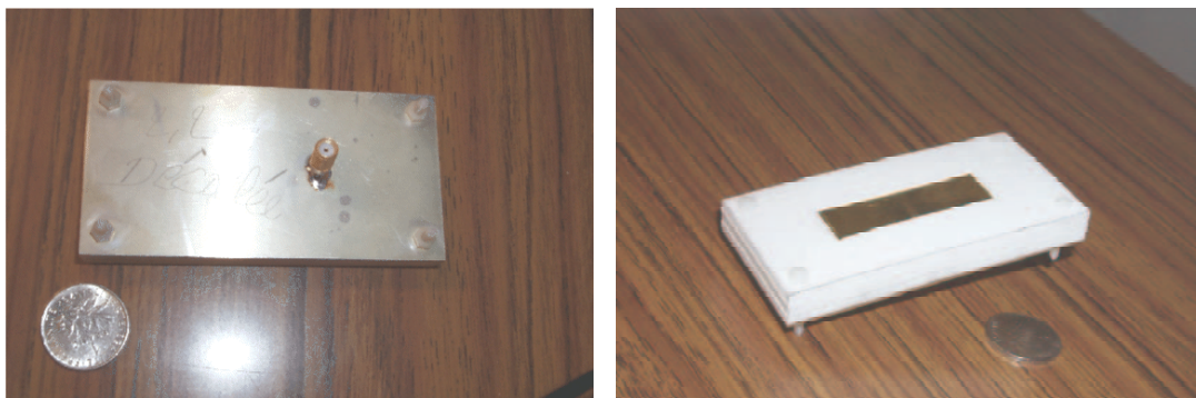
FIG. 4.5: Antenne unitaire pour les réseaux ULA d'émission et de réception
