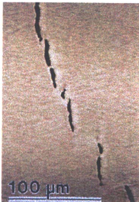
Fig. 4.11 – Observation in-situ de la fracture d'un alliage à base de Ti 3 Al. La fissure se propage via la nucléation, croissance et coalescence de cavités d'endommagements d'une taille 10 μm de long. (d'après [52])
